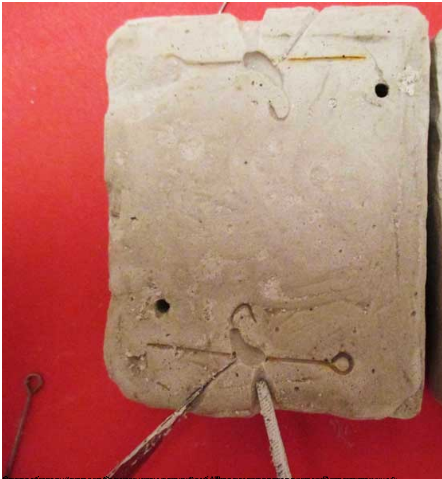
Сначала обрисовываем в гипсе контур мормышки. Затем делаем отверстие для крепления к леске.
